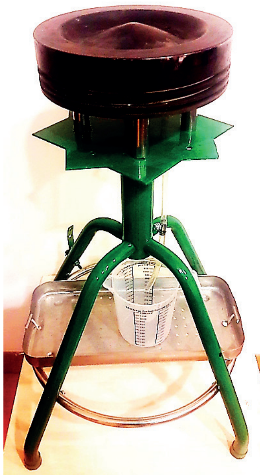
3-nji surat. Lokomotiwlerniň dizelleriniň gysyş derejesini kesgitlemek üçin abzal
