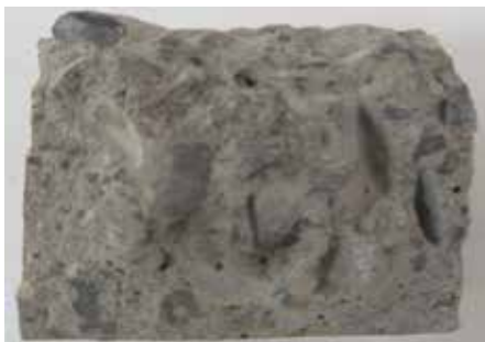
3-nji surat. Silikatlaşmagyň ýedi gije-gündizde aralaşmagy (beton döwügi)
